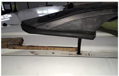
Kabeldurchgang innerhalb vom Dachrehling-Halter.
