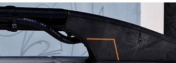
Dachreling-Halter vorne links mit Bohrer 10mm andurch) bohren.
